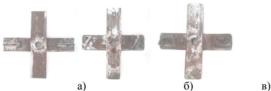
Рис.2.Конструкции роторов с различными молотками а) прямые молотки расположенные вдоль оси ротора ;б) молотки расположенные под углом 45 градусов к оси ротора; в) параболоидные молотки.
