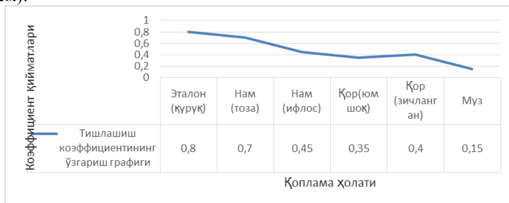
1-расм: Цементбетон қопламаларининг турли ҳолатларида тишлашиш коэффициентининг ўзгариши графиги
