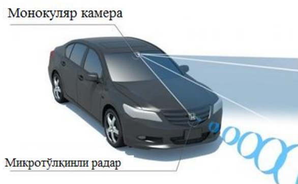
1-расм. Автомобилда техник кўриш мосламаларини жойлаштириш
